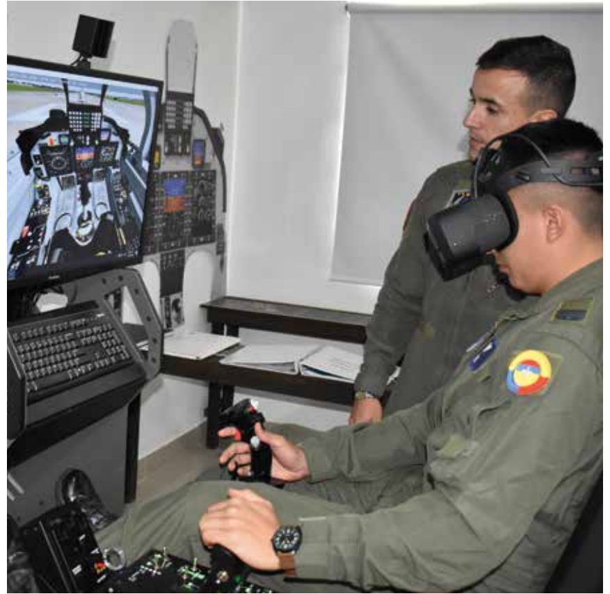
Cadete se entrena en el simulador de Realidad Mixta T-6C Texan II, que combina entornos físicos con proyecciones virtuales envolventes. Fotografía: Subteniente Verónica Julieth Chaverra Londoño.
